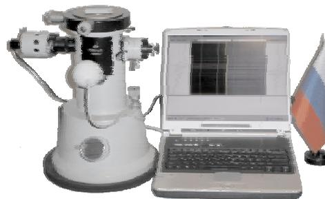
**Предназначены** для неразрушающего контроля параметров металлических или диэлектрических пленок в ходе технологического процесса и на готовых изделиях. Измерительный комплекс позволяет контролировать толщины металло-диэлектрических и поглощающих пленок в нанометровом диапазоне с недостижимой ранее точностью.
