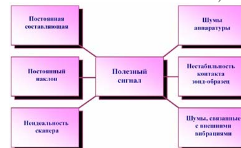
Рис. 15. Возможные искажения в СЗМ изображениях
